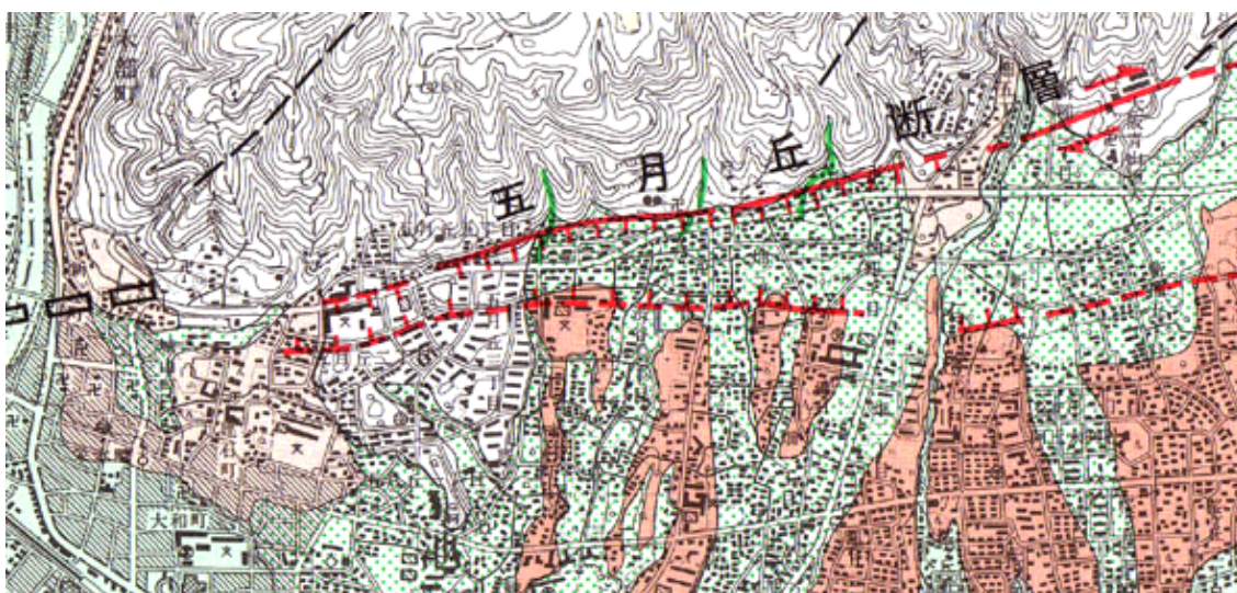
図2：活断層上に学校が存在することを示す1:25000都市圏活断層図「大阪西北部」（中田ほか, 1996）
