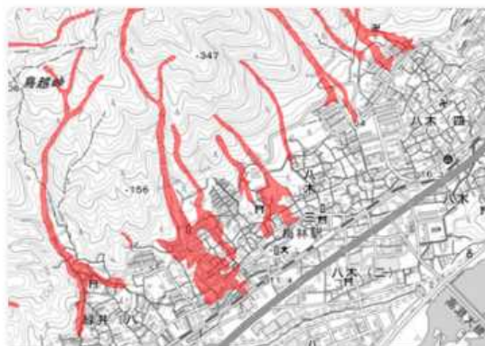
土石の流出範囲
