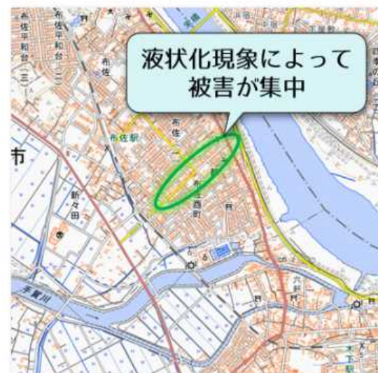
東北地方太平洋沖地震による 液状化現象によって被害が集中した地域
