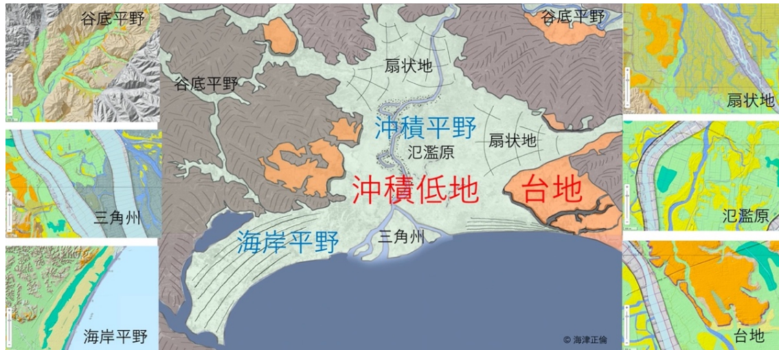
図 1 沖積低地の模式図と各種地形の地形分類図
