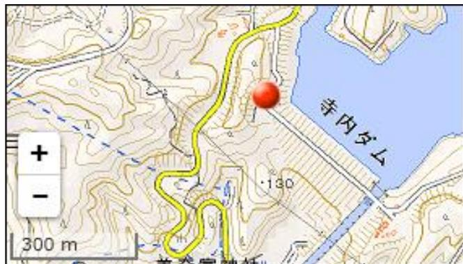
佐多川上流の寺内ダムは、堤高83m、堤頂長420m、総貯水容量1千800万 $m^3$ のロックフィルダムである。寺内ダムでは、今回の豪雨時に防災操作が実施され、多くの水と流木を貯留し、下流の洪水位を下げ、被害を低減できた。
