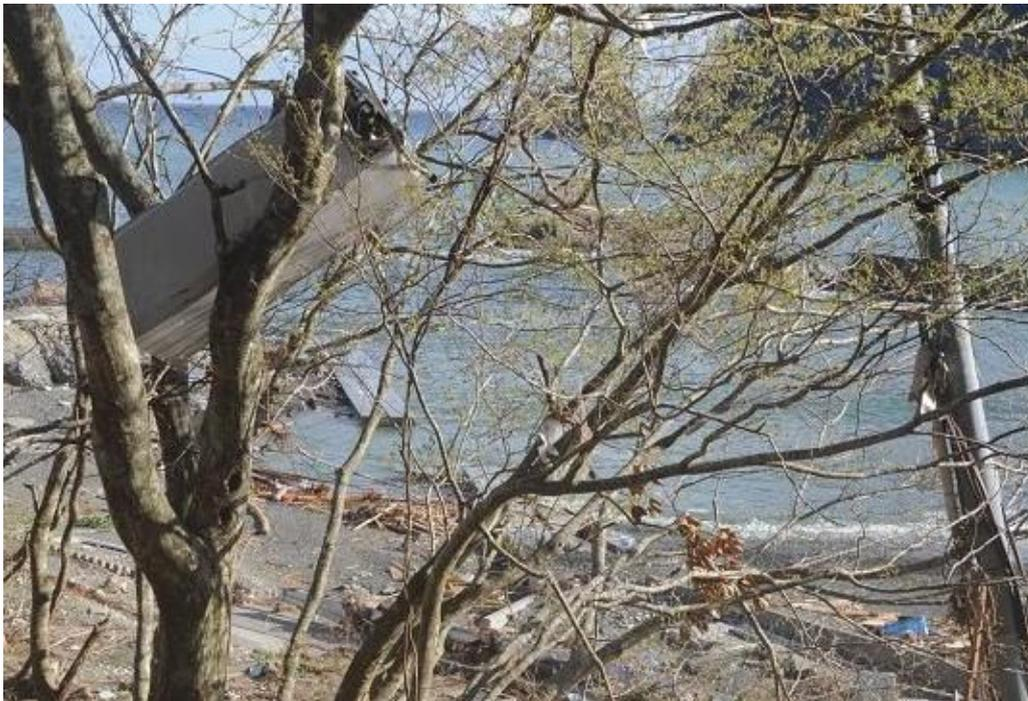
小谷鳥では海岸近傍の斜面の立木（海岸から高さ約 20m）に冷蔵庫がひっかかっている。その背後の神社の鳥居（海岸から高さ 23m）に破損が見られ、小谷鳥では海岸部で 20m 以上の波高があったと推定される。ここでは山際にあった住居の半数以上が被災した。
