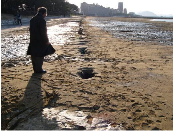
写真3 列状の噴砂跡 (西側人工海浜、 2005年3月20日撮影)
